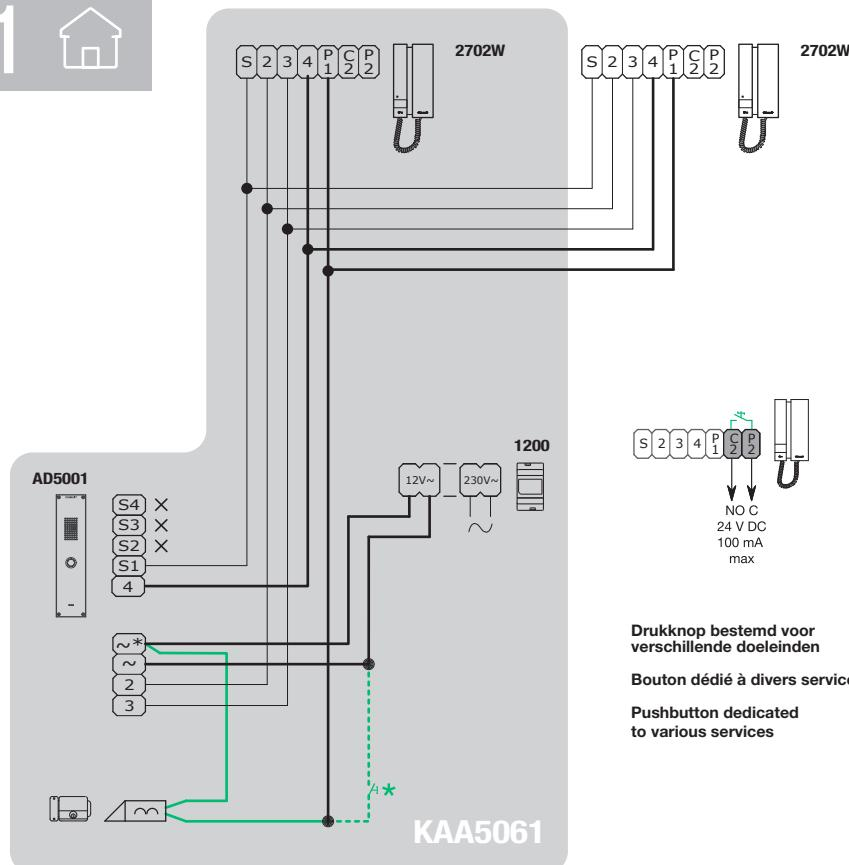
★ **Max 20 m.** Bedieningsknop lokale deuropener.**Max 20 m.** Bouton commande ouvre-porte local.**Max 20 m.** Local door-opener button.
